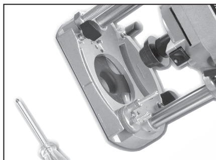
Всегда проверяете, чтобы копировальная втулка была соосна с фрезой, по возможности используя центрирующий конус (оправку).
